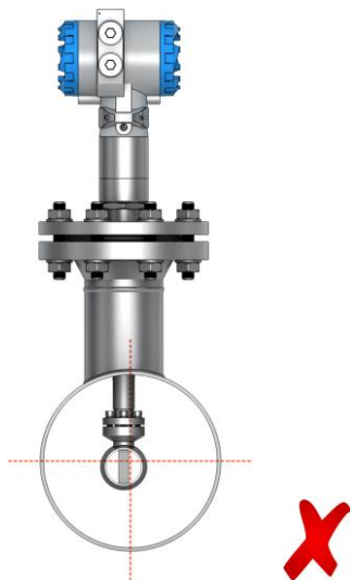
Рисунок 3.22 – Пример неверного монтажа зондового расходомера
