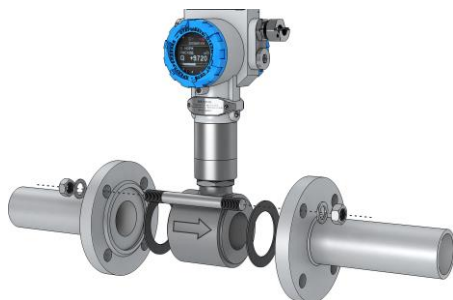
Рисунок 3.13 – Схема монтажа бесфланцевого (сэндвич) расходомера в трубопровод
