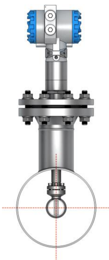
Рисунок 3.21 – Монтаж зондового расходомера
