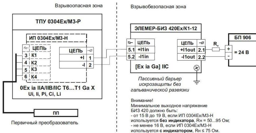
Рисунок А.7 - Схема электрическая подключений ТПУ0304Ex/M3-P во взрывоопасной зоне (вариант 2)
