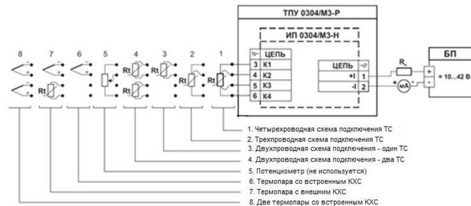
Рисунок А.2 - Схема электрическая подключений ТПУ 0304/М3-Р к ТС и ТП и по токовой петле без индикатора.
