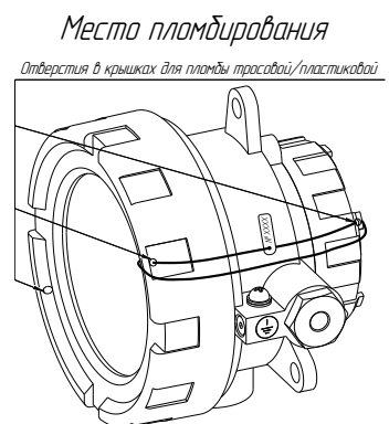
Рисунок А.3 - Место пломбирования УПП-11/М1, УПП-11/М1L
