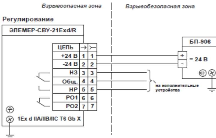
Рисунок Г.8 - Схема электрическая подключения сигнализаторов ЭЛЕМЕР-СВУ-21Exd с кодом при заказе R (с релейным выходным сигналом)
