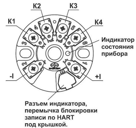
Рисунок 2.1 - Функциональное расположение клемм, органов управления и индикации ИП 0304/M3-H-D44
