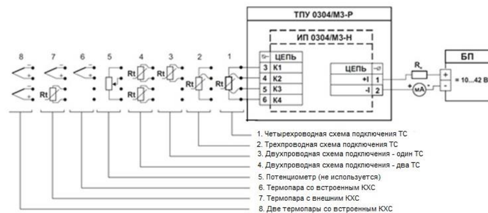
Рисунок А.1 - Схема электрическая подключений входных цепей ТПУ 0304/М3-Н по токовой петле без индикатора
