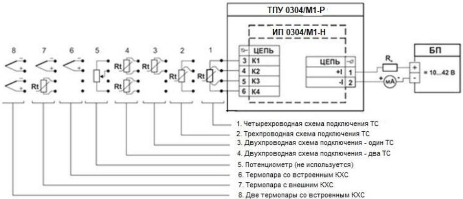
**Рисунок А.2** – Схема электрическая подключений ТПУ-0304/M1-P к ТС и ТП и по токовой петле без индикатора
