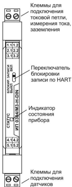
Рисунок 2.4- Функциональное расположение клемм, органов управления, индикации ИП 0304/M3-H-DIN Вид со снятой крышкой
