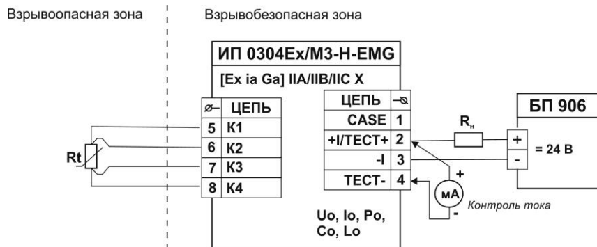
Рисунок А.21 - Схема электрическая подключений ИП 0304Ex/M3-H-EMG вне взрывоопасной зоны
