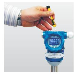
С клавиатуры доступны основные функции меню преобразователя: изменение диапазона измерения, корректировка «нуля», задание времени демпфирования, уставок и гистерезиса, выбор единиц измерения. Следует отметить, что доступ к системе встроенного меню прибора защищен паролем.
