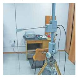
НПП «ЭЛЕМЕР» имеет собственную испытательную лабораторию по испытаниям приборов на воздействие различных видов помех. В разнообразных тестах на «выносливость» приборы подвергаются разносторонним влияниям, которые возможны на реальных измерительных точках. Среди этих тестов — испытания на микросекундные импульсные помехи (МИП), наносекундные импульсные помехи (НИП), радиочастотные помехи, магнитное поле промышленной частоты и т.д.
