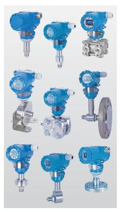
В зависимости от модели преобразователи ЭЛЕМЕР-100 имеют 6 или 8 переключаемых пределов (диапазонов) измерений. Соотношение между верхним и нижним пределом измерений составляет 25:1. Датчики выпускаются со следующими пределами допускаемой основной погрешности: ±0,1%; ±0,15; ±0,25% или ±0,5%.
